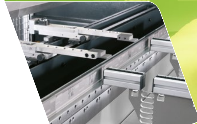
Backgauge using X, R and Z1 + Z2-axis
